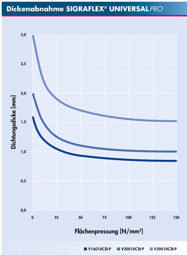
Dickenabnahme von SIGRAFLEX UNIVERSAL PRO in Abhängigkeit von Dichtungsdicke und Flächenpressung in eingebautem Zustand
