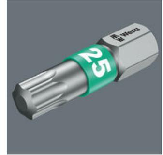
BTZ-Bits haben eine angelassene Bit-Torsion-Zone, wodurch die Härte des Schaftes um ca. 20 % gegenüber der Abtriebspitze reduziert wird. Dadurch wird das Verwinden der Bit-Spitze bei auftretenden Belastungsspitzen größtenteils vermieden, was die Lebensdauer des Bits noch weiter erhöht.
