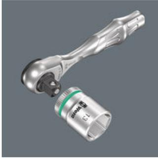
Die Zyklop Mini 3 Knarre ist das ideale Werkzeug für Verschraubungen in beengten Schraubsituationen. Die Feinverzahnung (60 Zähne) ermöglicht einen sehr geringen Rückholwinkel von nur 6°; das Rändelrad erlaubt das schnelle Schrauben, selbst wenn kein Platz für die Schwenkbewegung ist.
