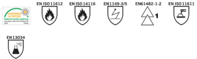
Zertifiziert nach EN 531/EN ISO 11612 (A1, B1, C1, E1), EN 533/EN ISO 14116 (Index 3/50x75° C), EN 1149-3 und EN 1149-5, EN 61482-1-2 (Klasse 1) / getestet nach IEC 61482-1-1 (cal 18,2 cal/cm<sup>2</sup>), EN 470-1/EN ISO 11611 (Klasse 1 A1) und EN 13034 (Typ 6).
